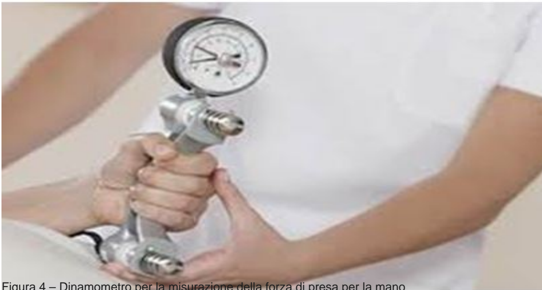
Figura 4 – Dinamometro per la misurazione della forza di presa per la mano
