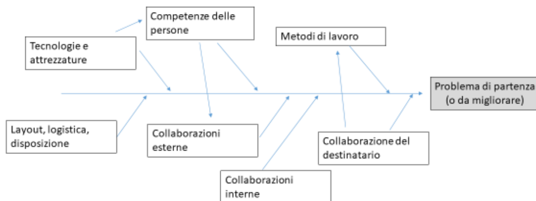
Strumento 2 – diagramma per l'analisi delle cause di Ishikawa
