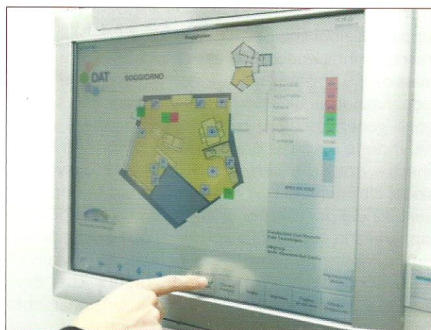
Figura 1 - Il pannello di supervisione della casa domotica del servizio DAT.
